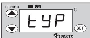
■ 히터/냉각 선택모드 : 온도 설정 모드 상태에서 **SET** 키를 누르면 'typ' 가 표시됩니다. 이 때 **SET** 키를 한번더 누르면 'H' 또는 'C' 표시가 점멸되는데, **▲** 키를 누르면 'H' 표시가 되고, **▼** 키를 누르면 'C' 표시가 됩니다.
