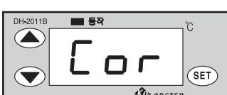
■ 온도보정모드 : 온도편차모드에서 **SET** 키를 누르면 'Cor' 이 표시됩니다. 이 때 **SET** 키를 한번더 누르면 온도보정값의 표시가 점멸되는데, **▲** 키나 **▼** 키를 눌러서 온도보정값을 조정합니다. 조정범위는 ±9.9°C입니다. 현재온도가 표준온도와 맞지 않을 때 현재의 온도를 기감하여 교정합니다.
