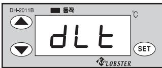
■ 냉각지연 모드 : 히터/냉각선택 모드에서 **SET** 키를 누르면 'dLE' 가 표시됩니다. 이 때 **SET** 키를 한번더 누르면 냉각지연 시간값의 표시가 점멸되는데, **▲** 키나 **▼** 키를 눌러서 냉각지연 시간을 조정합니다. 초기값은 180초(3분)이며, 설정 범위는 0~999초(약16분)입니다. 냉각기가 동작되는 온도조건이 되면 냉각지연시간후에 냉각기의 출력이 ON됩니다. 냉각지연시간은 냉각기의 수명을 보호합니다.
